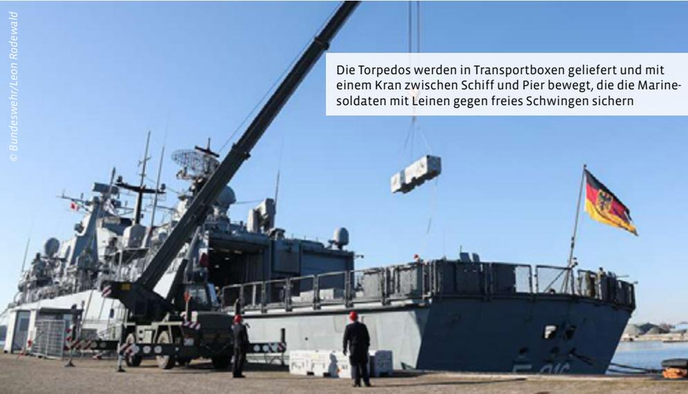
Die Torpedos werden in Transportboxen geliefert und mit einem Kran zwischen Schiff und Pier bewegt, die die Marinesoldaten mit Leinen gegen freies Schwingen sichern
