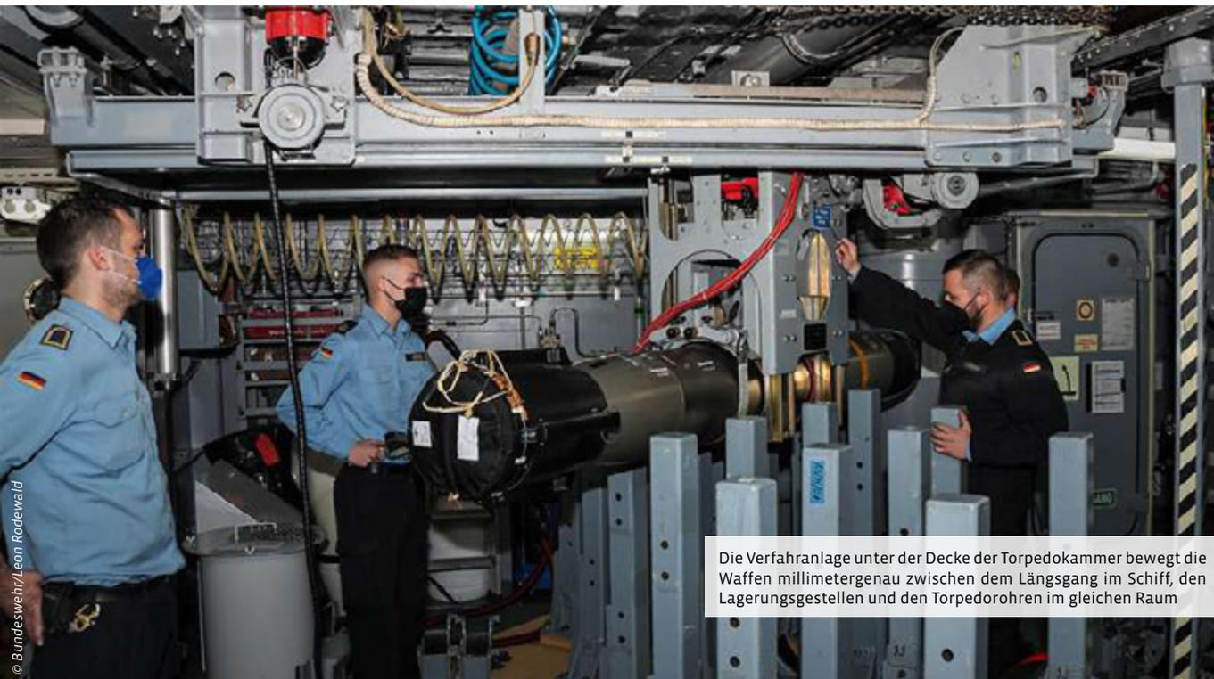
Die Verfahranlage unter der Decke der Torpedokammer bewegt die Waffen millimetergenau zwischen dem Längsgang im Schiff, den Lagerungsgestellen und den Torpedorohren im gleichen Raum
